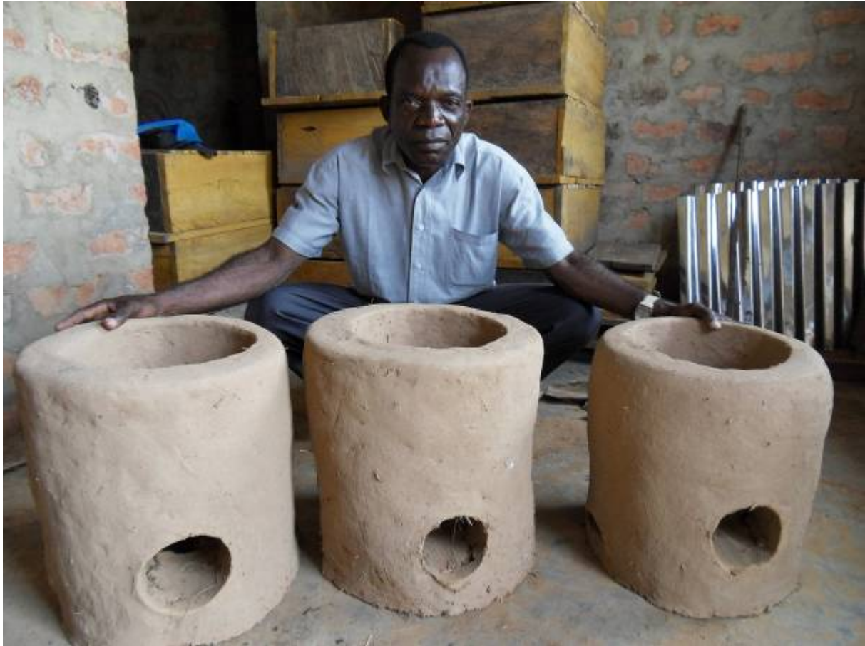
Lorena-Lehmöfen sparen Brennholz und entlasten Frauen und Kinder
